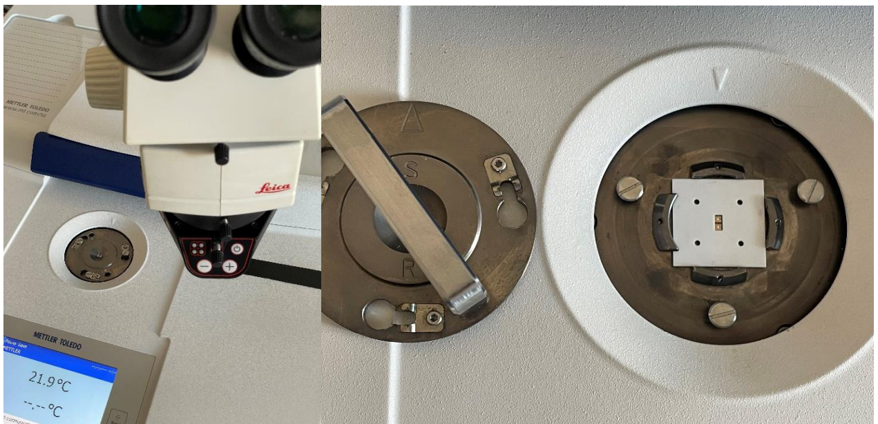
Рисунок 7 – Сверхбыстрый калориметр FSC1. Вид на калориметр и встроенный микроскоп (слева), держатель чип-сенсора (справа).
